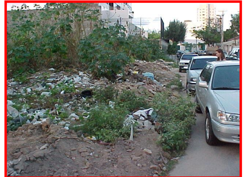
Resíduo de construção depositado nas vias públicas
